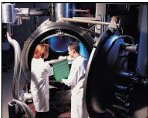
> D'après une photo de la chambre à vide au CNES où s'effectuent les essais thermiques en environnement spatial. © CNES/Romaric Tisserand
